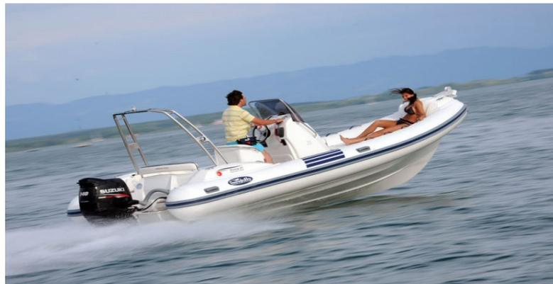
Der neue leichte und kompakte Suzuki DF140A Motor ermöglicht gigantische Leistungen, da er nur 179 kg wiegt. Merkmale wie ein zweistufiger Nockentrieb sowie eine versetzte Antriebswelle machen den DF140A zum kompaktesten Viertaktmotor überhaupt. Er ist damit die ideale Antriebsart für eine Vielzahl von Booten und Anwendungen.
