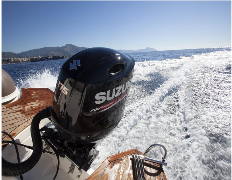
In dem modernen "Big Block"-Reihenvierzylindermotor ist die gesamte Technik von Suzuki verbaut. Die Technik und die überwältigende Kraft lassen nur einen Gedanken zu: WOW. Der Klopfsensor, die variable Ventilsteuerung und das semi-direkte Mehrstufenansaugsystem haben zu einer drastischen Verbesserung der Motorleistung geführt. Der O<sub>2</sub>-Sensor, der Wassermelder und das Ausgleichswellensystem bieten Komfort und Langlebigkeit.
