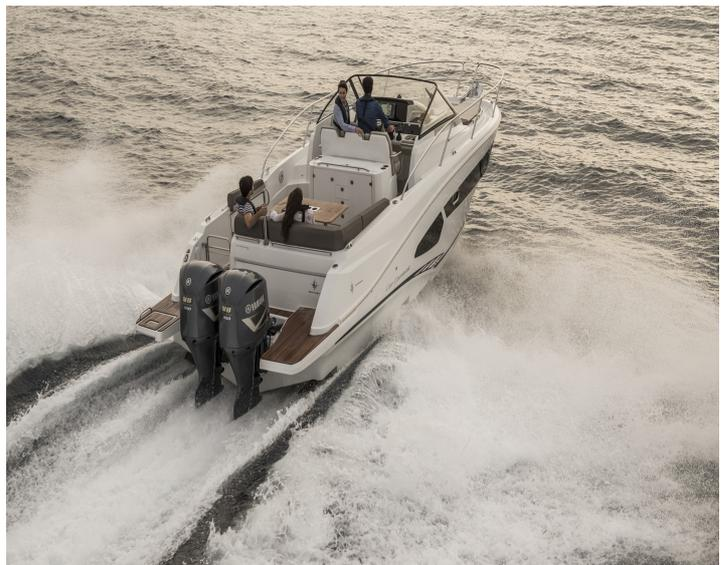
**Der leistungsstarke 5,3-Liter-Motor Yamaha F350 ist ein echter technischer Pionier, der die hohen Anforderungen großer Offshore-Boote problemlos meistert. Dieser Viertakt-V8-Motor ist einer der größeren Außenbordmotoren und kombiniert hohe Leistungs- und Drehmomentwerte mit kultivierter Leistung, wie sie für moderne Rumpfkonstruktionen erforderlich ist.**
