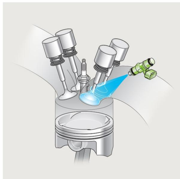
Um optimale Leistung und Wirtschaftlichkeit zu gewährleisten muß das Kraftstoff/Luftgemisch immer präzise angepaßt werden. Hierfür messen sieben verschiedene Sensoren ständig sämtliche Bedingungen.
