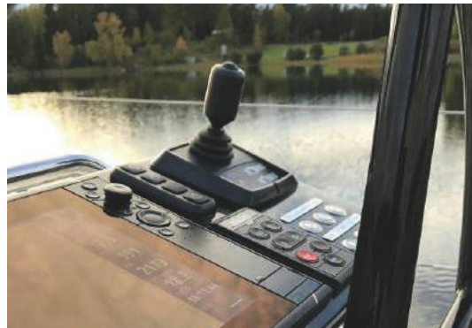
Ein Beispiel für den vollständig am Steuerstand integrierten V-DOCKER
