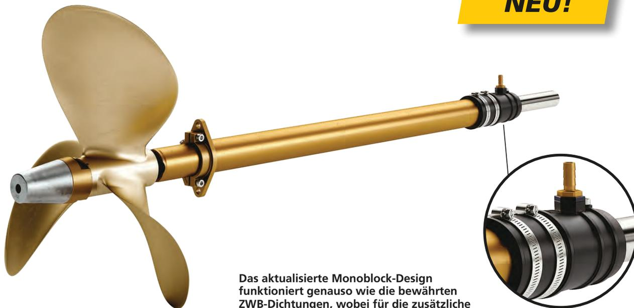
Das aktualisierte Monoblock-Design funktioniert genauso wie die bewährten ZWB-Dichtungen, wobei für die zusätzliche Sicherheit eine zusätzliche Lippe (insgesamt drei) hinzugefügt wurde.
