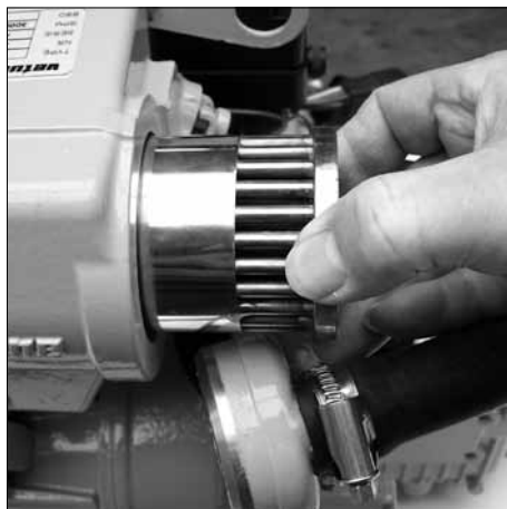
59. Tage varmeveksleren ud
