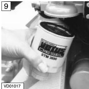
9 Ein neues Kraftstofffilterelement montieren (S. 36).
