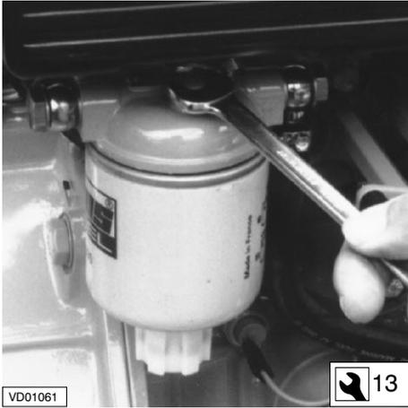
Öffnen Sie die zwei Entlüftungsnippel und der Entlüftungsvorgang vollzieht sich schneller.
