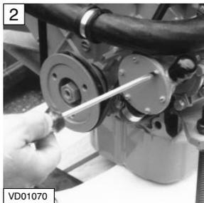
Überprüfen, ob der Deckel der Außenwasserpumpe und die Ablasschrauben montiert sind (S. 40, 42).
