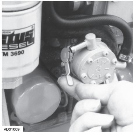
Bedienen Sie die Kraftstoffpumpe, um das System durchzupumpen.
