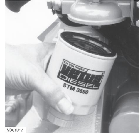
Ein neues Kraftstofffilterelement montieren (S. 36).
