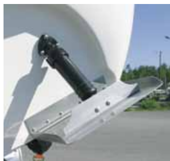
Trimmklappen – Satz, Bennett 109, 12 V, Hydr.-Zylinder, Trimm- klappen, Hydr.-Pumpe, Kontroll- schalter, zum nachträglichen Einbau
