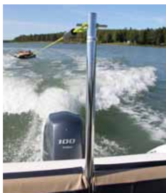
Wasserskistange, Edelstahl, max. Zuggewicht: 100 kg
