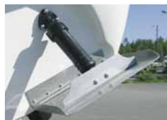
Trimmklappen – Satz, Bennett 109, 12 V, Hydr.-Zylinder, Trimmklappen, Hydr.-Pumpe, Kontrollschalter, zum nachträglichen Einbau 10" x 9" (25 x 23 cm)
