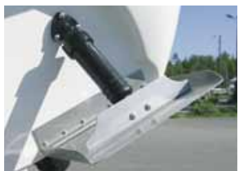
Trimmkappen – Satz, Bennett 109, 12 V, incl. Hydr.-Zylinder, Trimmkappen, Hydr.-Pumpe, Kontrollschalter, zum nachträglichen Einbau
