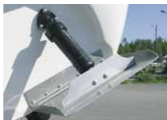
Trimmkappen – Satz, Bennett 129, 12 V, incl. Hydr.-Zylinder, Trimmkappen, Hyd.-Pumpe, Kontrollschalter, zum nachträglichen Einbau 12"x9" (30 x 23 cm)
