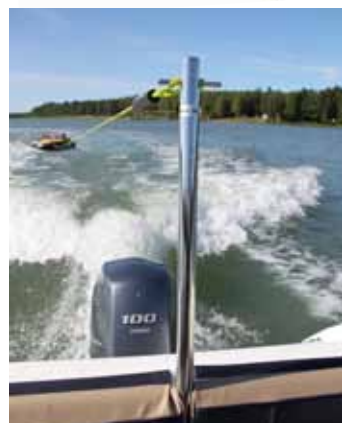
Wasserskistange, Edelstahl max. Zuggewicht: 100 kg
