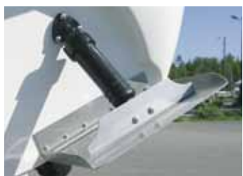
Trimmklappen – Satz, Bennett 129, 12 V, incl. Hydr.-Zylinder, Trimmklappen, Hydr.-Pumpe, Kontrollschalter, zum nachträglichen Einbau 12"x9" (30 x 23 cm)
